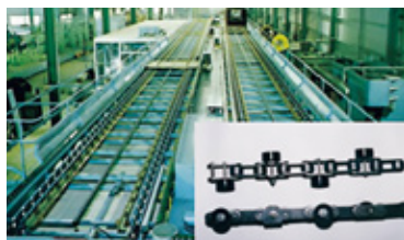
「MEPチェーン」コンベヤ 製品を作業者の前で停止する作業者視点のフリー フローシステムを採用
