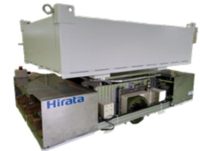
1tonタイプAGV(動作テスト機)
