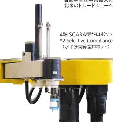
4軸 SCARA型\*2ロボット「ARM-BASE」
