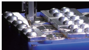
電池の電極間にワイヤーをボンディングする様子(ズーム撮影)
