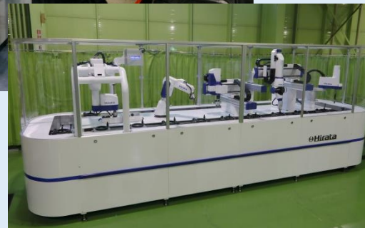
ロボット5台による 組立ラインのデモ
