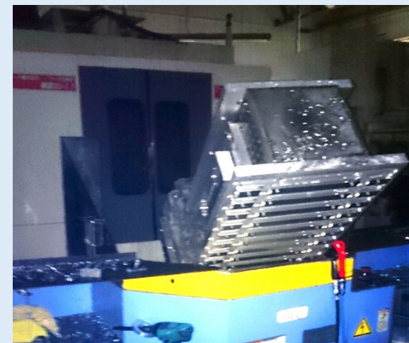
加工機の上で傾いた加工品取付用の治具
