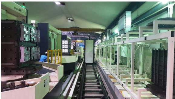
左に工作機械3台、中央に走行軸と搬送ロボット、右がストッカーの例
