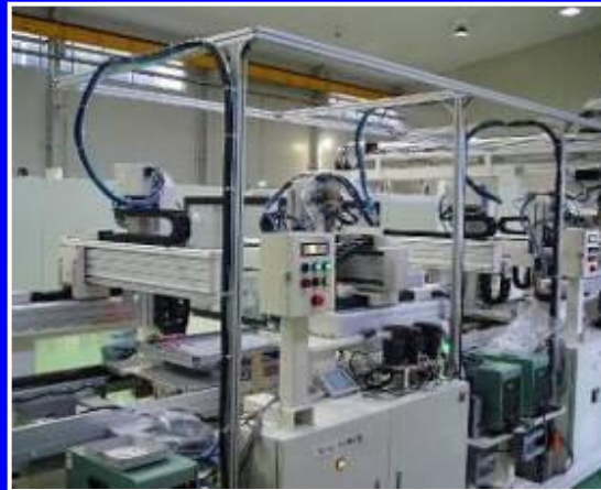
薄型テレビ自動組立設備
