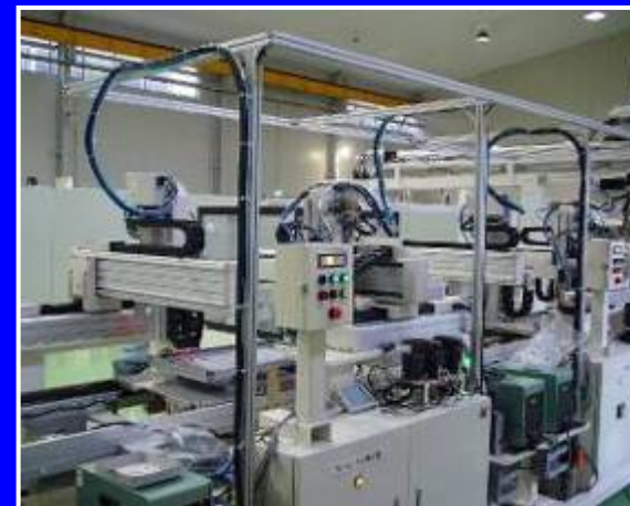
薄型テレビ自動組立設備
