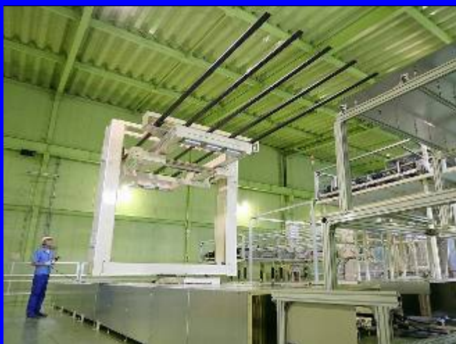
ガラス基板およびソーラーパネル 搬送ロボット
