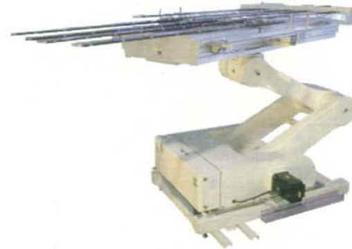
FPD(フラットパネルディスプレイ)関連設備 ガラス基板搬送ロボット
