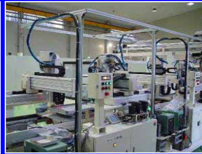
薄型テレビ自動組立設備
