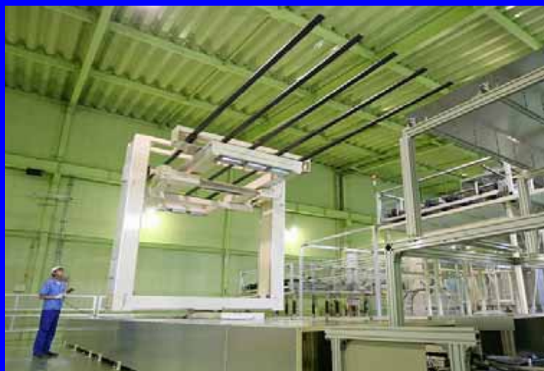
世界最大級 大型ガラス基板搬送ロボット
