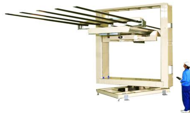
第10世代対応 ガラス基板搬送ロボット
