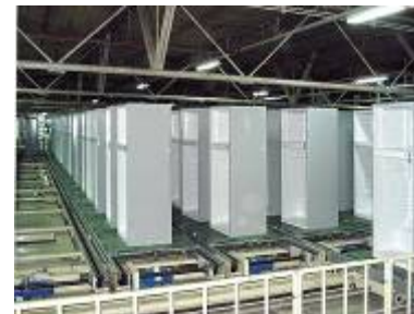
冷蔵庫組立設備
