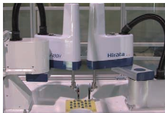
協調動作をしながら、ピー玉移載のデモンストレーションをする2台のロボット
