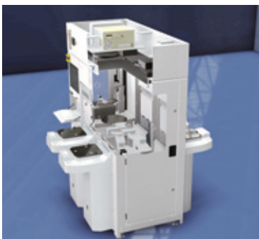
ロードポート、ウェーハ搬送ロボット、アライナーなどを組み合わせた300mmEFEM/ソーターの例
