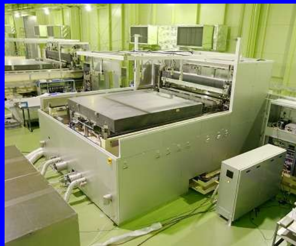
感光剤（レジスト） 塗布装置のコーターシステム
