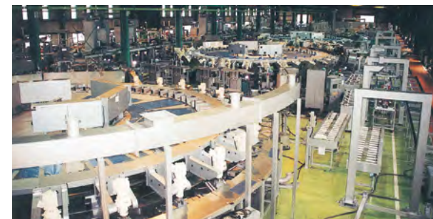
ロボット技術を活かしたブラウン管生産ライン
