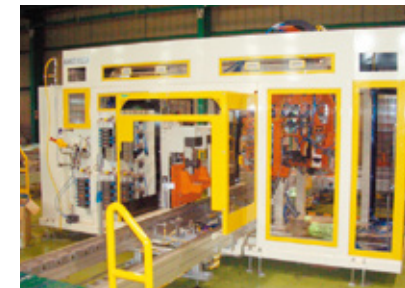
エンジンのリークテスト装置 (加圧減圧の漏れ検査)
