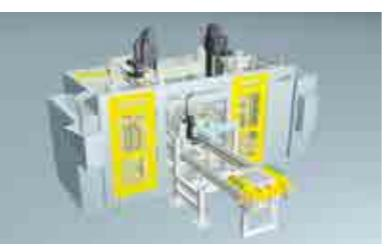
缸盖气阀组装装置
