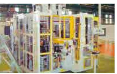
自动变速箱的行星架组装装置
