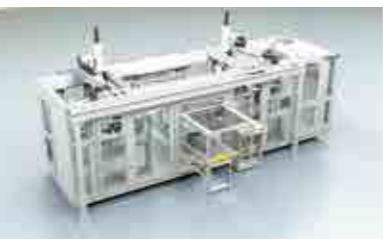
自动变速箱的离合器组装装置
