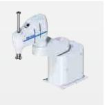
吊装架水平多关节机器人 AR-T 系列
