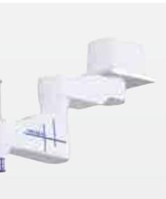
天吊り水平多関節ロボット
