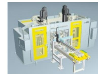
缸盖气阀组装装置
