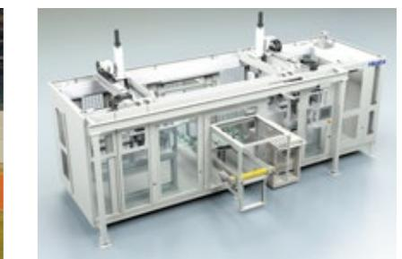
自动变速箱的离合器组装装置
