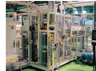
エンジンのピストン挿入装置
